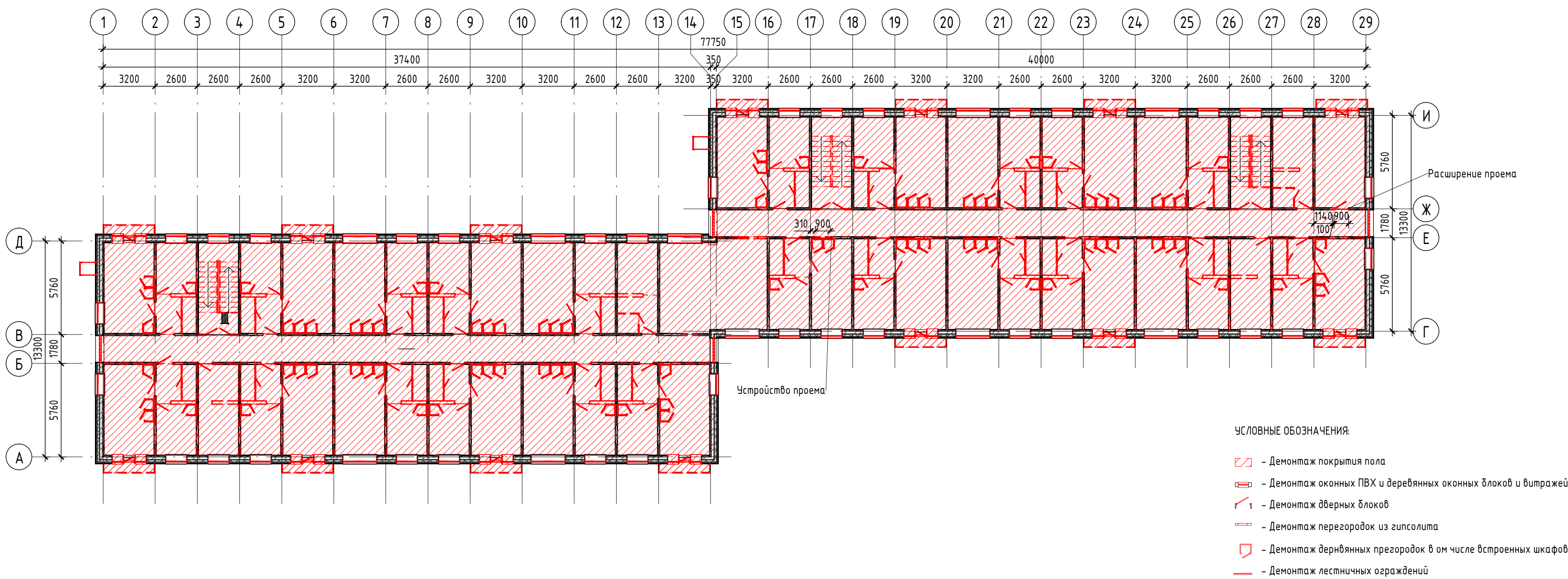
План 5-го этажа. Демонтаж ( 1 : 200 )
