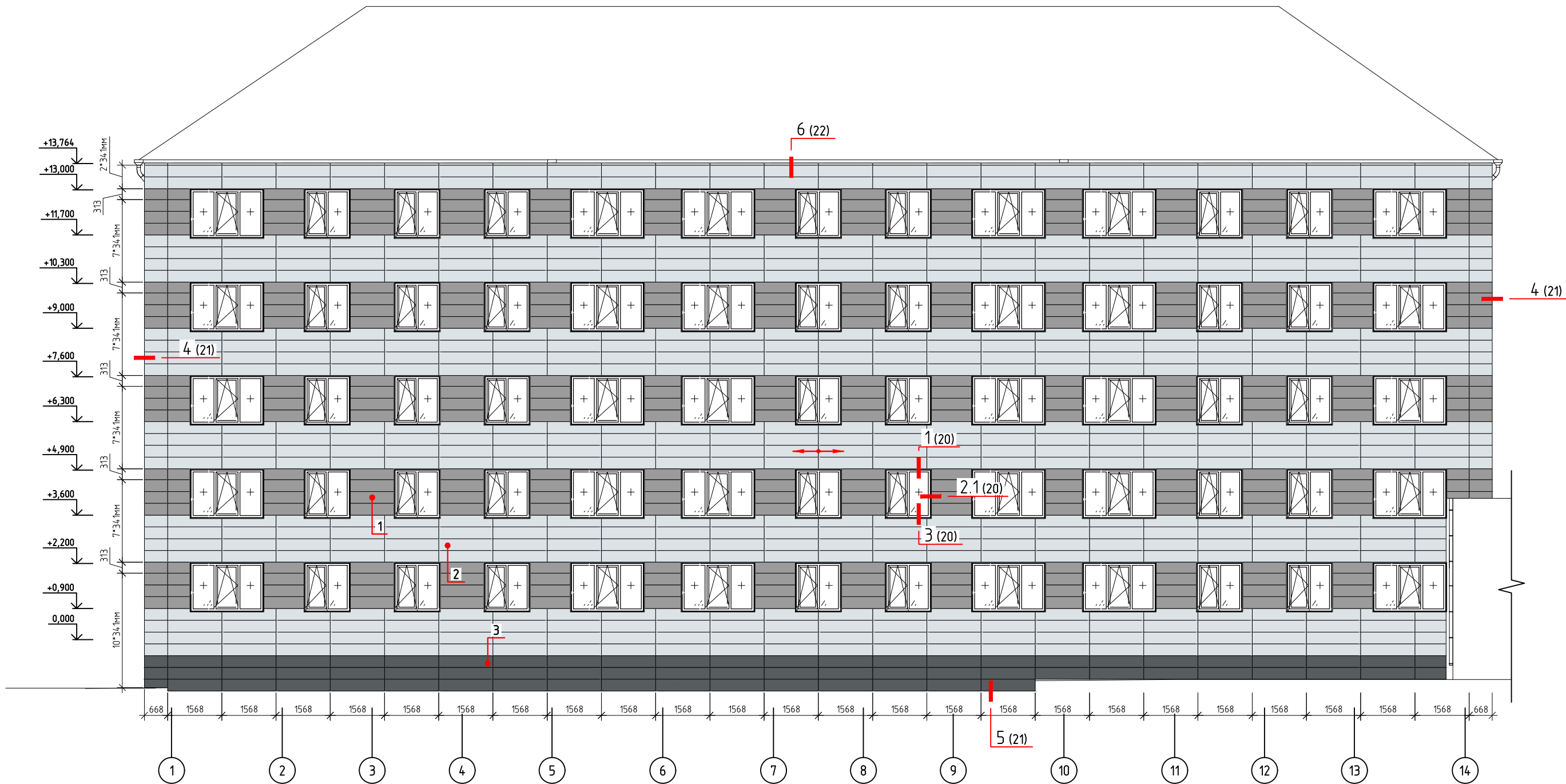
Ф-4. Фасад 1-14. Раскладка фасадной облицовки.
