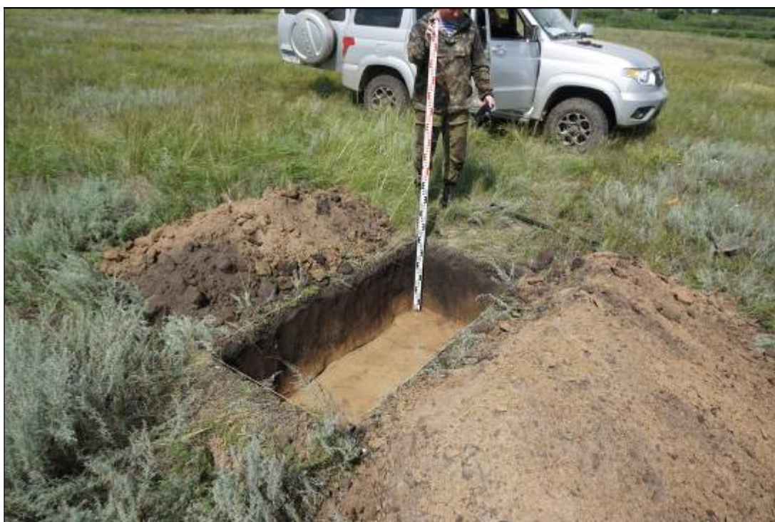
Приложение 139. ФОТО. Обследование земельных участков под размещение объекта «Газопровод межпоселковый ГРС Электродный завод - р.п. Сузун с газопроводами-отводами для газоснабжения населенных пунктов Искитимского и Сузунского районов Новосибирской области» Сузунский район, с. Битки. Участок шурфовки № 4. Разведочный шурф № 14. Вид с ЮВ.
