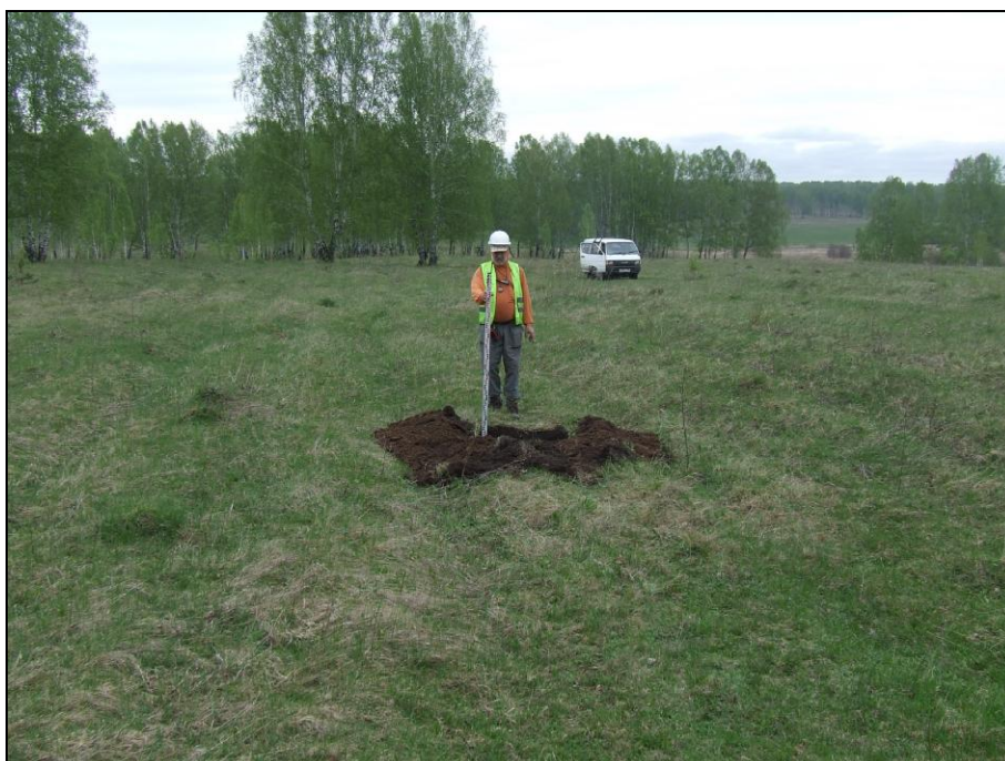
Рисунок 23. ФОТО. Строительство канализационных очистных сооружений глубокой биологической очистки в городе Болотное Новосибирской области. Разведочное вскрытие (шурф) № 2. Вид с Ю. Высота масштабной рейки 2 м.
